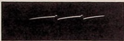
Bild 168. Oszillogramm des Gitterspannungsverlaufs am ersten Multivibratorgitter; dieses Gitter ist während des größten Teils der Impulsperiode verriegelt
