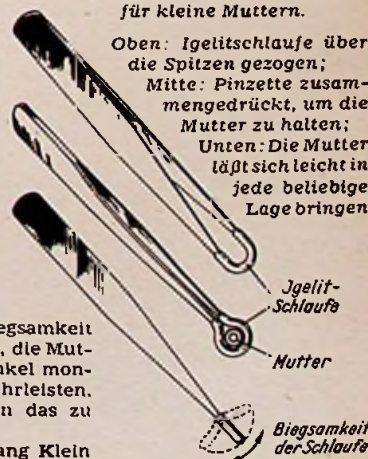
Pinzette als Haltevorrichtung für kleine Muttern.
